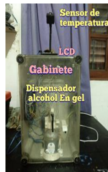
Imagen de gabinete con el montaje del sensor de temperatura y el dispensador de gel
